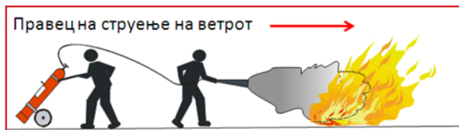
Слика бр. 39. Гаснење пожар со превозен ПП-апарат од типот „CO 2 “ -10 kg
