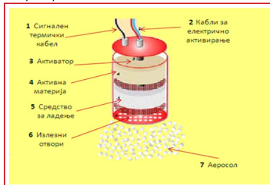
Слика бр. 63. Состав на аеросолен генератор
