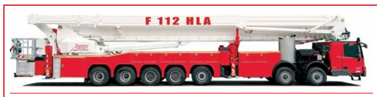
Слика бр. 71. Телескопска зглобна платформа од 112 m
